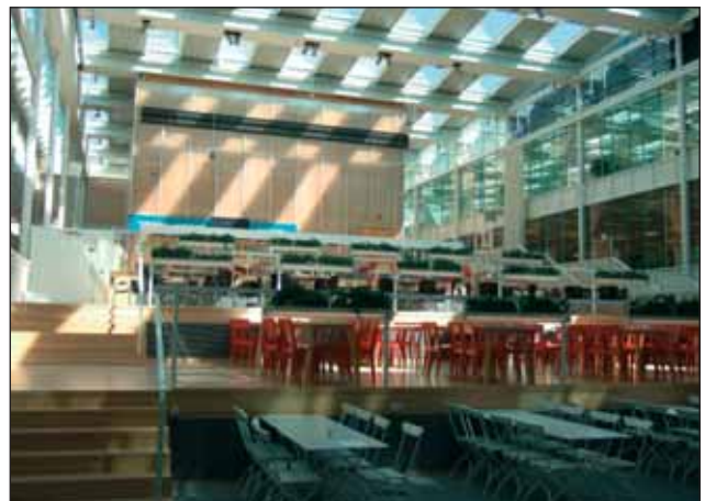
Bild 3. Das Kunst- und Tageslicht im Lichtthof kann mittels Fernbedienung den jeweiligen Bedürfnissen angepasst werden. Quelle: Energoretea
